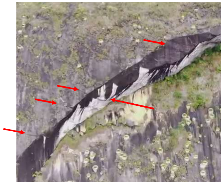
Figura 6 – No topo, bloco diagrama esquemático indicando a possibilidade da queda de bloco/matacão gerar trincas com o impacto possibilitando geração de novas rupturas, que se agregam ao movimento, ou deixam blocos isolados que em condições específicas podem se romper. Foto abaixo do bloco diagrama indicando planos das foliações nítidos, sugerindo que contribuem para rupturas.
