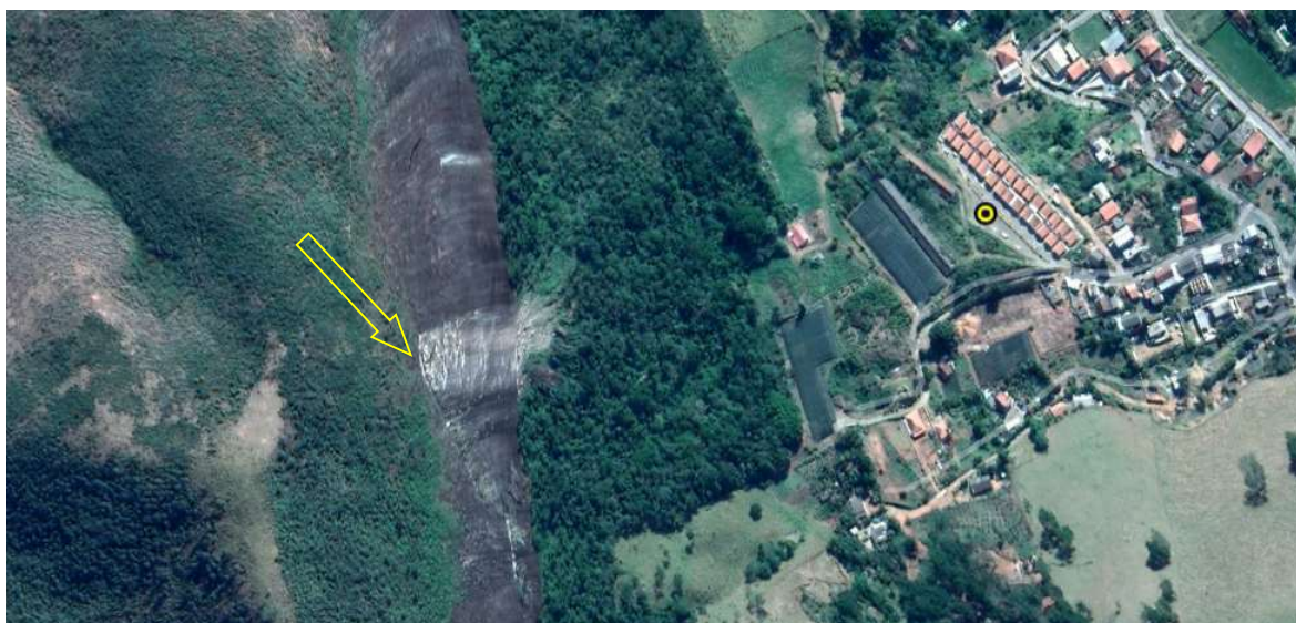
Figura 3 – Imagem do Google Earth de Julho de 2018 onde pode ser identificada área de ruptura na encosta rochosa em 2018. Ponto amarelo- ponto de referência deste relatório.
